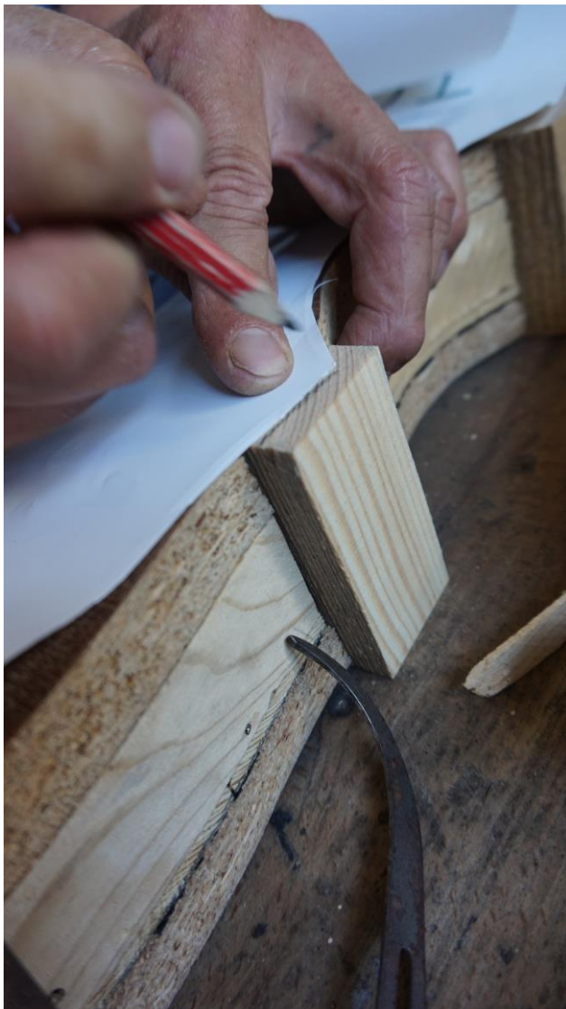
Odwzorowanie szablonu na klocku
