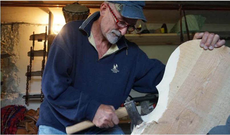
Zgrubna obróbka płyty z zewnątrz
