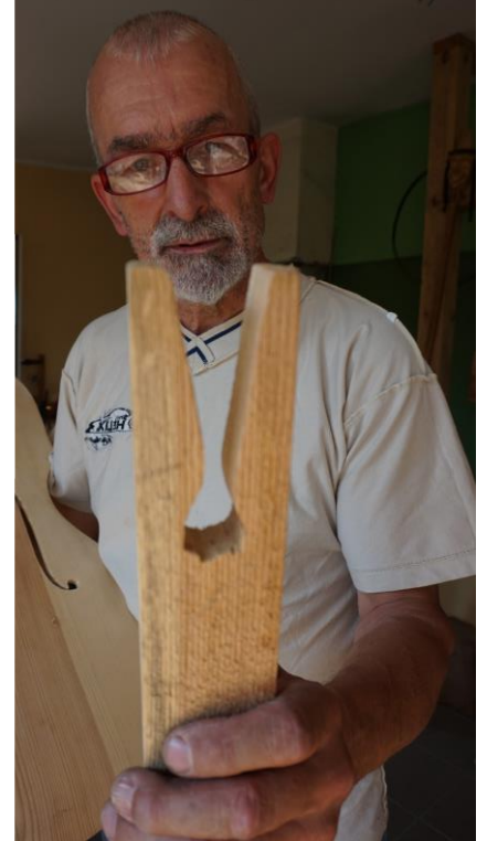
Przyrząd ułatwiający wycinanie „efów” za pomocą piłki włosowej
