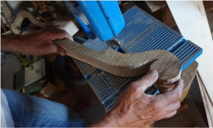
Wycinanie szyjki instrumentu
