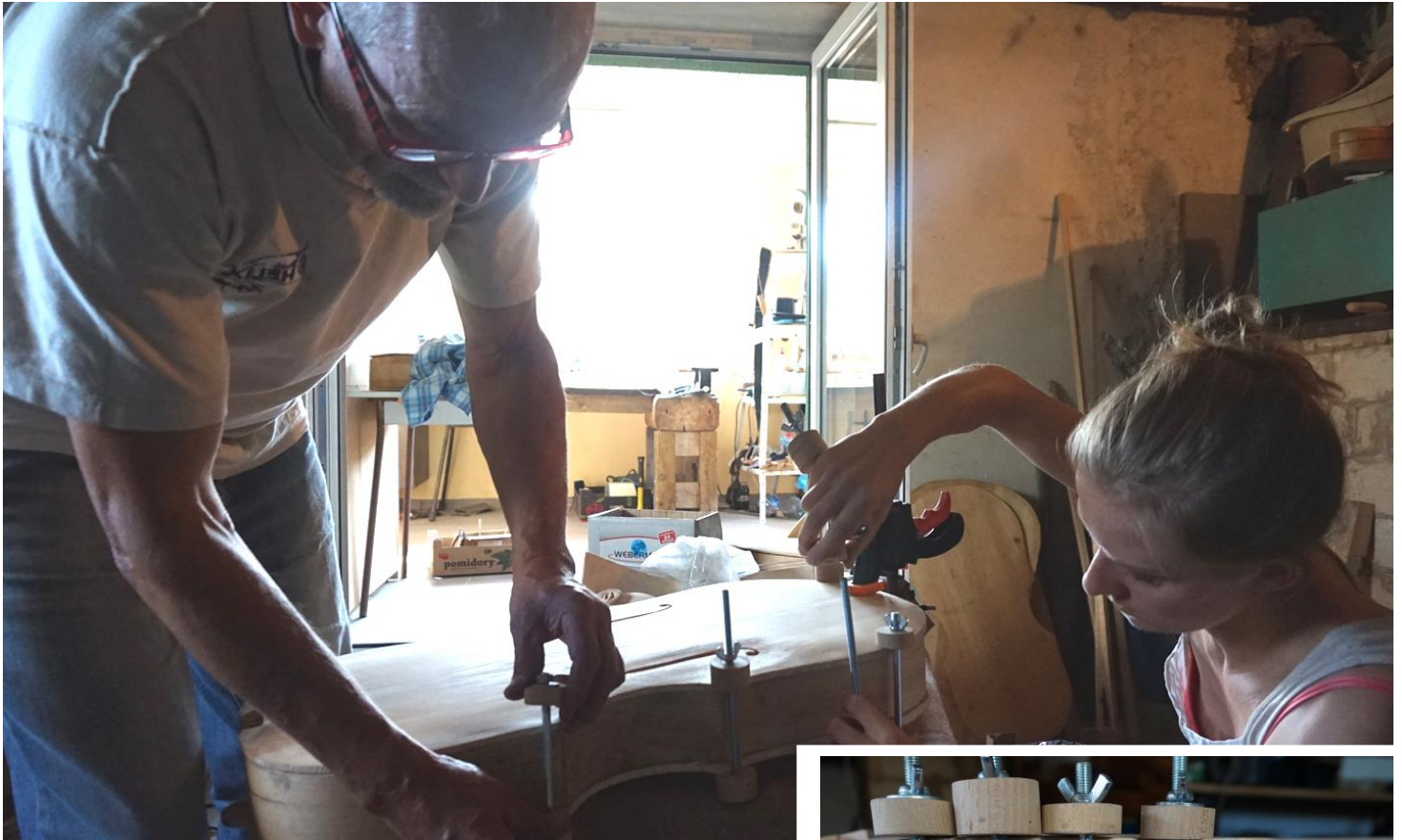
Dociskanie płyt górnej i dolnej do wieńca
