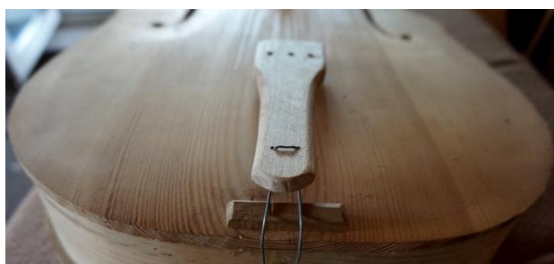
Montaż strunociągu i dolnego prozka
