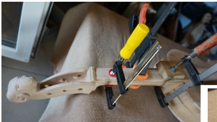
Klejenie podstrunnicy do szyjki
