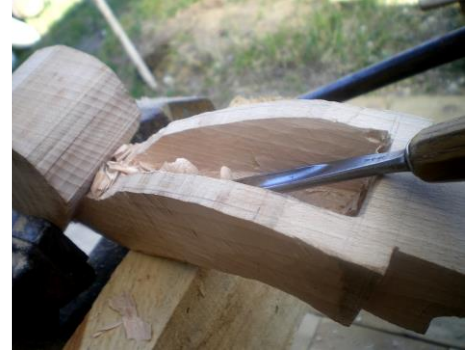
Dłutowanie komory kołkowej
