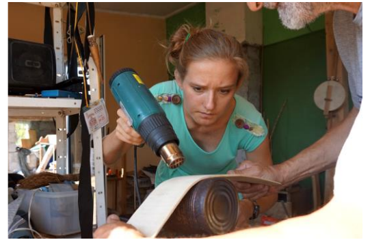
Wyginanie boków. Nagrzewarka elektryczna i puszka po ogórkach zastępują giętarce lutniczą
